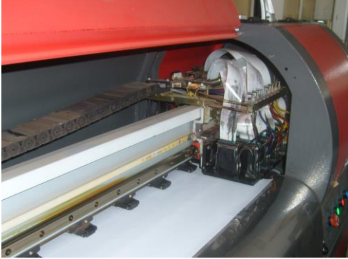
Resim 2.29: Baskı kafalarının konumunun ayarlanması
