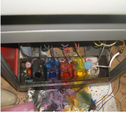
Resim 2.28: Baskı kafalarının mürekkep transferi kontrolü
