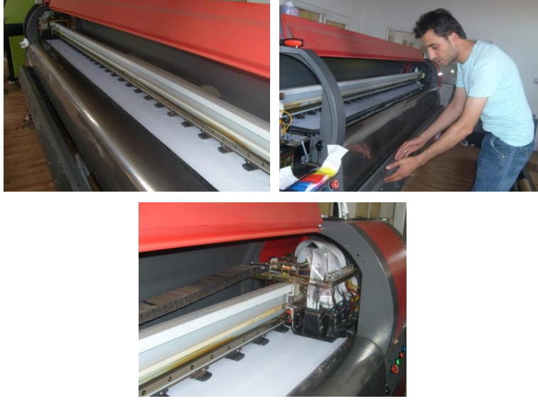
Resim 1.15: Baskı kafalarının ayarlanması
